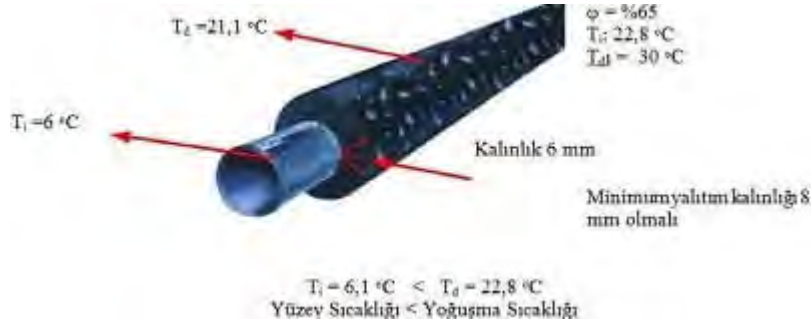
Şekil 1.3: Isı yalıtımı yetersiz yapılırsa yoğuşma yüzeyde olur.
