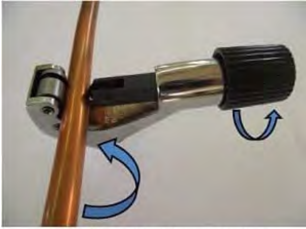
Bakır boru makası ile borunun kesilmesi
