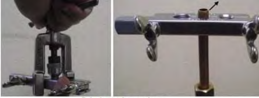
Bakır boruya havşa açılması
