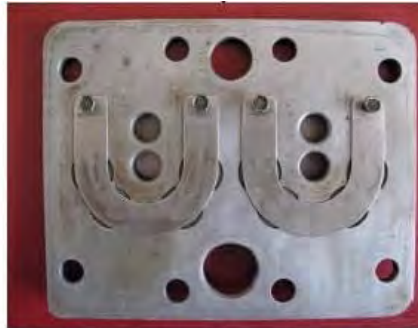
Resim 2.4: Valf pleytine montajlı basma valfi Resim 2.5: Valf pleytine montajlı emme valfi
