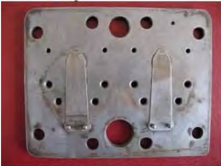
Resim 2.4: Valf pleytine montajlı basma valfi Resim 2.5: Valf pleytine montajlı emme valfi
